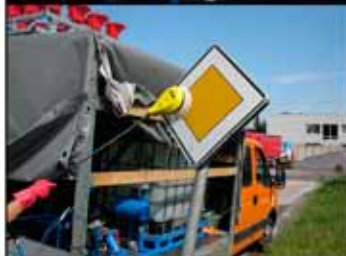
◀ Nadstavbu môžete využiť aj na čistenie zvislého dopravného značenia, odrazových zrkadiel smerových stĺpikov
